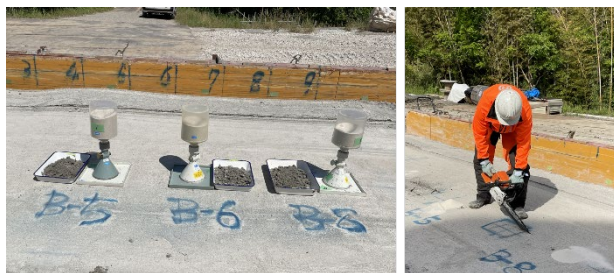
(a) 砂置換試験
