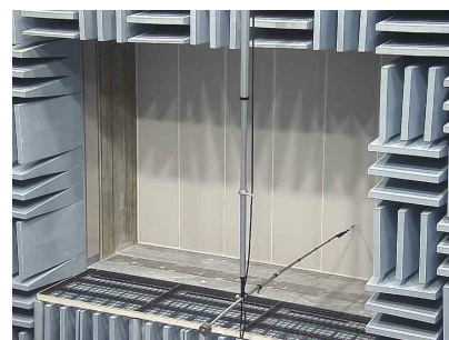
無響室側（トラバース装置）
