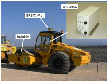
写真-1 振動ローラに搭載するシステム構成
