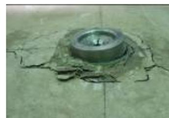
写真-2 せん断実験破壊状況
