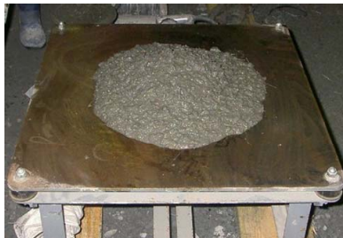
写真-1 加振前のスランプ性状
