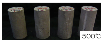
写真-1 加熱冷却後の供試体状況
