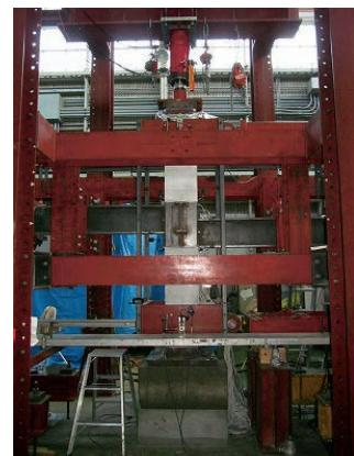
写真-1 柱梁接合部実験状況
