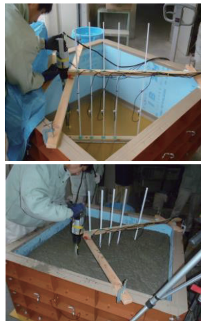
写真-1 締固め実験状況
