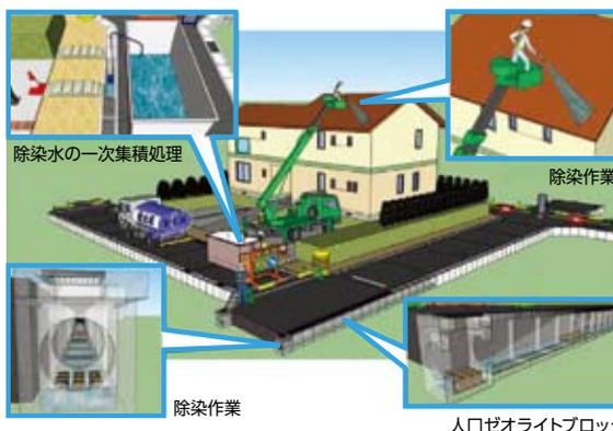
図3: 除染エリアにおける水処理イメージ
