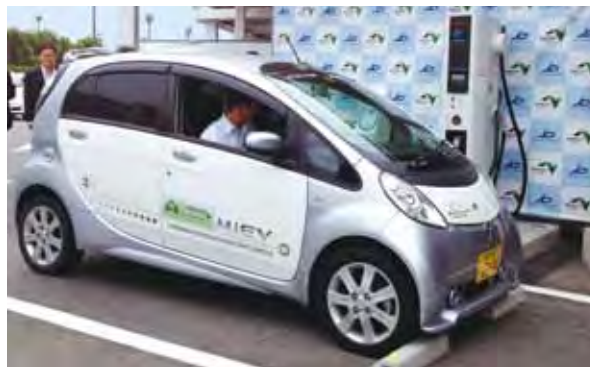
高速道路PAに設置された急速充電器とEV
