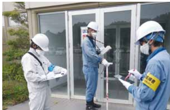
タブレット端末を用いた放射線量モニタリング
