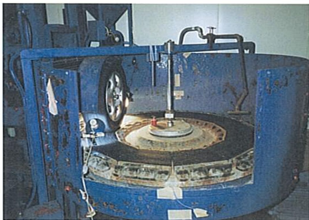
写真-4 回転ラベリング試験状況
