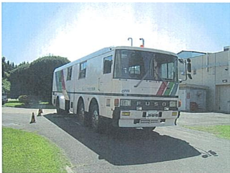
写真-1 路上タイヤ特性試験車
