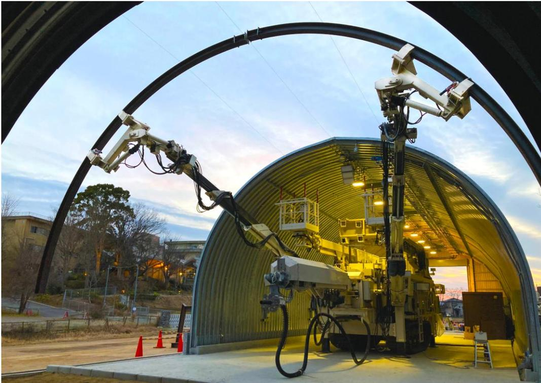
模擬トンネルにおける全自動鋼製支保工建込みロボット全景
