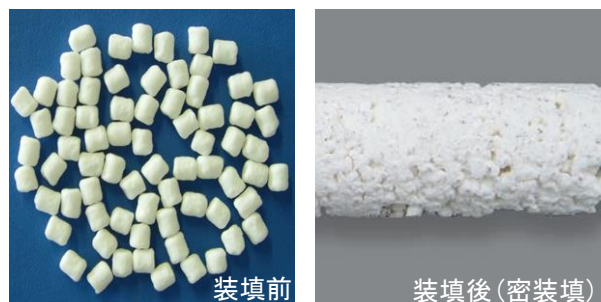
写真 7 粒状爆薬例(「ランデックス」:カヤク・ジャパン製)
