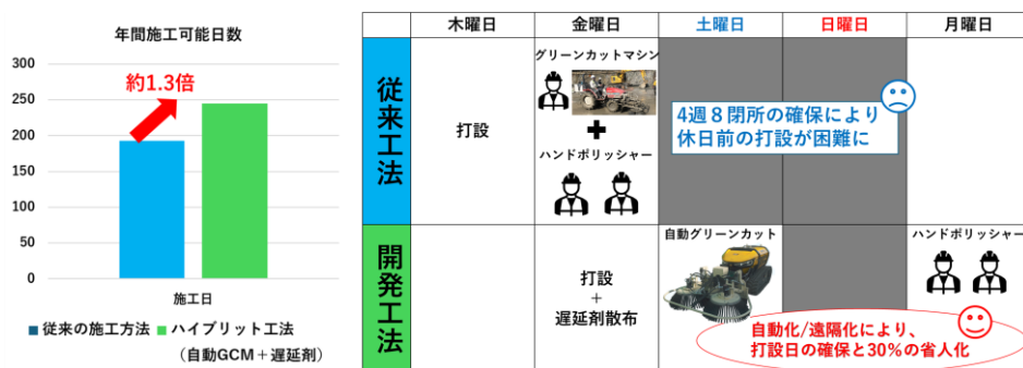
図-2 従来工法と開発技術の比較
