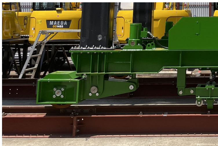
写真-3 「どすこいガントリー」の鉄輪昇降機能
