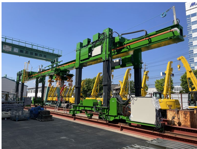
写真-1 連結式半断面床版架設機「どすこいガントリー」
