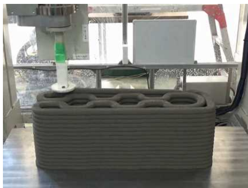
室内用コンクリート3D プリンターによる造形(壁の部分モデル)
